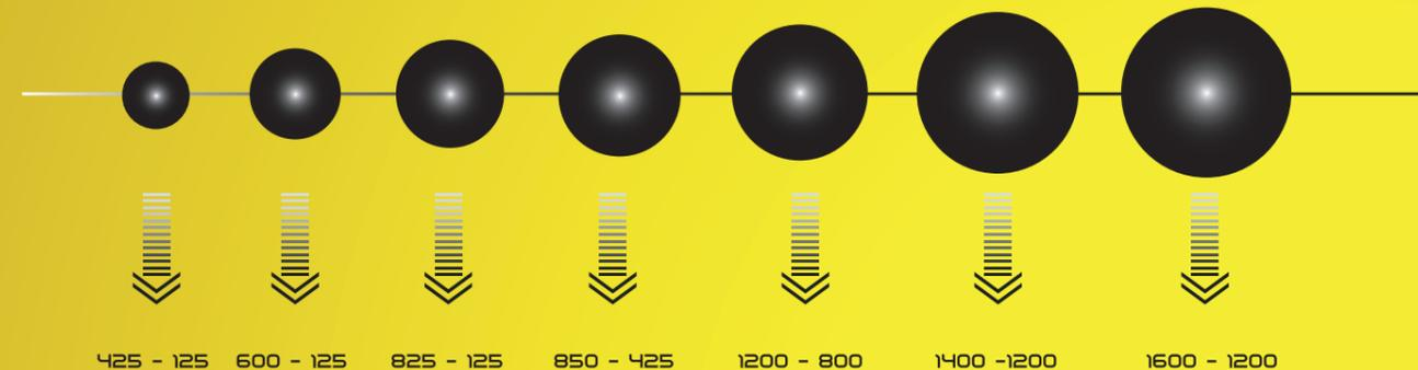
La granulometria delle microsfele ULTRAGUARD™ è compresa tra i 150 µm et 850 µm
