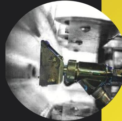
Pistola a spruzzo per l'applicazione delle microsfele di ULTRAGUARD™
